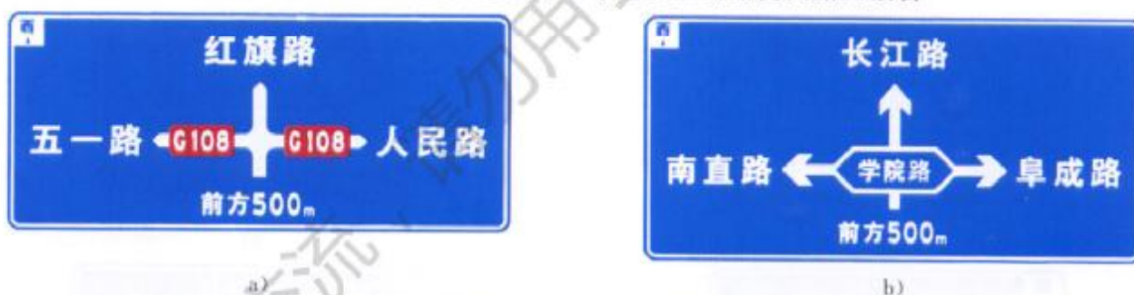
图 190 路 3 箭头杆上标识公路编号、道路名称的公路交叉路口预告
