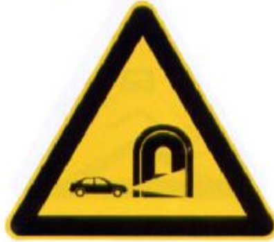
图 61 警 40 隧道开车灯
