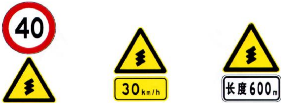
a) 和限制速度标志(禁 38)联合使用 b) 和建议速度标志(警 39)联合使用 c) 附加说明连续弯路长度的辅助标志
